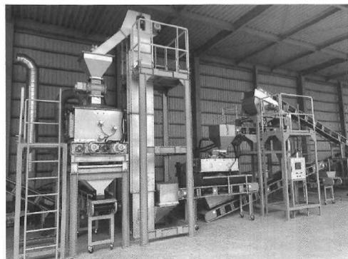
（写真1）ペレットマシーンに冷却機を加えたプラント
